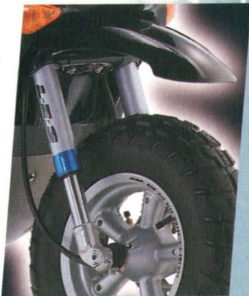
Die Upside-Down Hydraulik-Gabel für höchste Ansprüche
